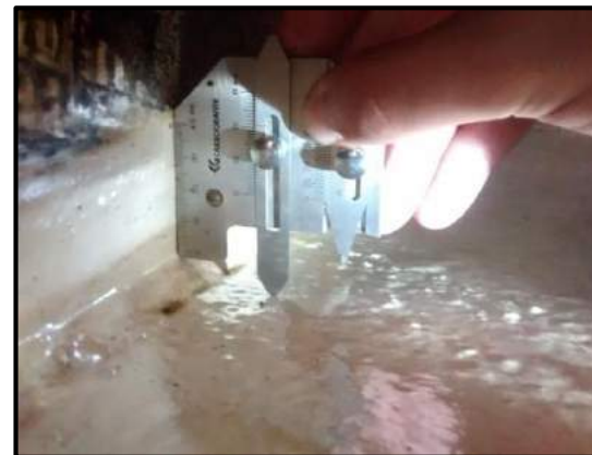
Dimensional na solda de ligação costado e fundo (externo e interno)
